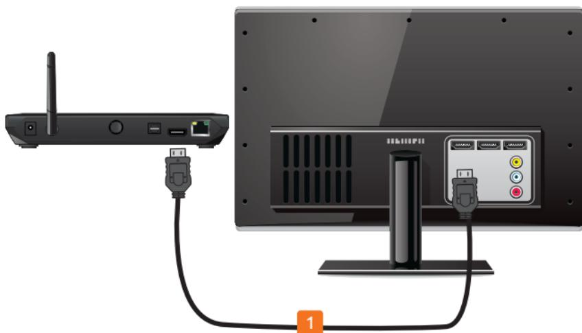
Соедините приставку с уже **включенным** телевизором при помощи HDMI-кабеля. При помощи пульта телевизора выберите номер HDMI разъема, к которому подключен кабель.
